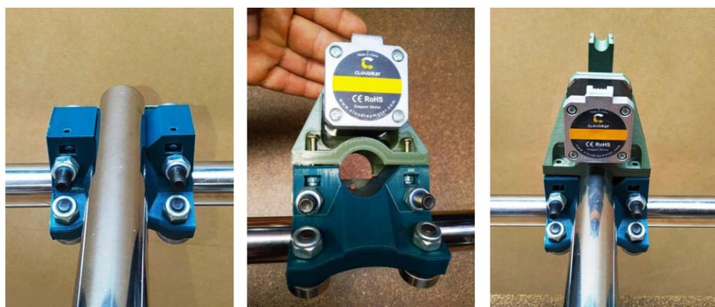
Una vez ajustados los 4 motores, puede agarrar la pieza central y desplazarla por toda la máquina. Hágalo suave, recuerde que las esquinas aún no se han fijado a la mesa.
